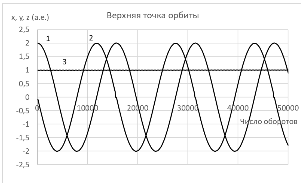
Рис. 1. Движение небесного тела с учетом притяжения Юпитера. Показаны координаты x (1), y (2) и z (3) верхней точки траектории, координата z практически не изменяется
