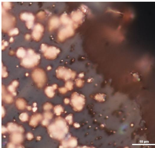
Рисунок 3.5. Микрофотография разрушенного композита ТМ/Сu с наклонными порами в микроскопе Nikon Eclipse LV100.
